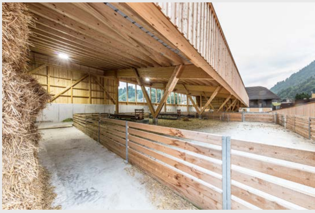
Lage im Gelände und ungewohnte Stallhaltung ergeben eine neue Bauform: Vom Betrachter abfallender Boden, gegensinnige Neigung des Dachs auf V-Stützen, offener Zugang Stall-Laufhof mit Sichtschutz zur Straße.
