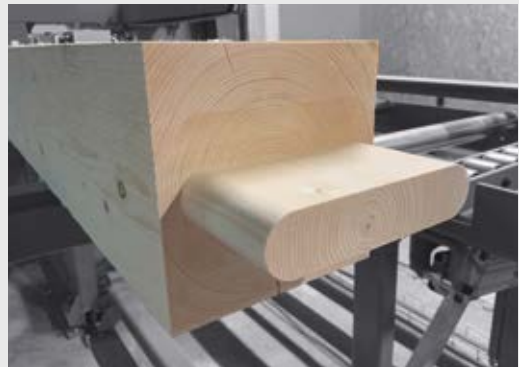
Manche Holzverbindungen wirken wie geschnitzt; die computergestützte Bearbeitung ahmt Details traditionellen Zimmerer-Handwerks nach.
