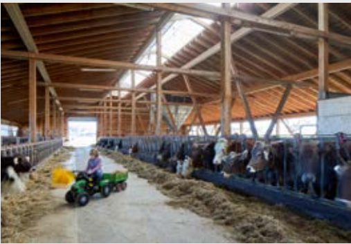
Der Futtertisch als erweiterter Hof-Spielplatz. Rechts die Abstützung der Pfetten in V-Form im Liegebereich.
